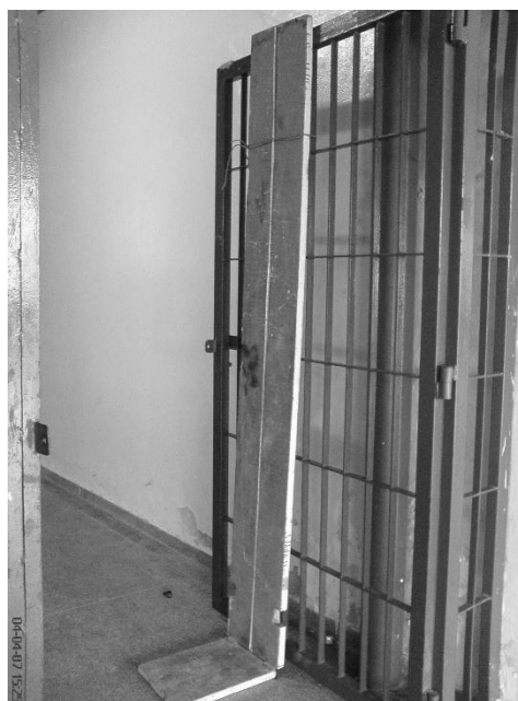
Figura 2: Estadiometro, feito com fita métrica e madeira
