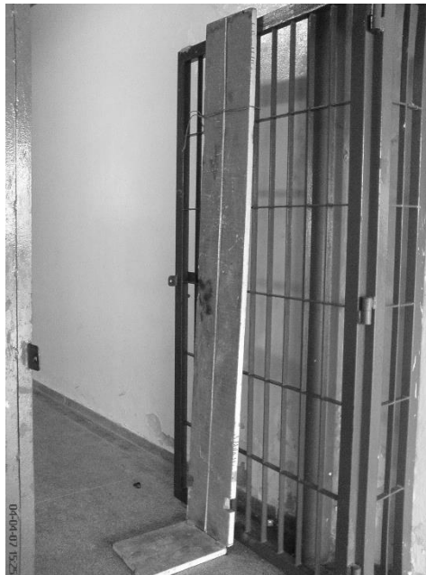
Figura 2: Estadiometro, feito com fita métrica e madeira
